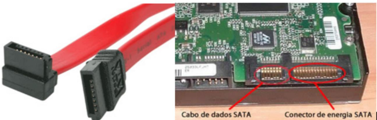
Os cabos possuem apenas sete fios, sendo um par para transmissão e outro para recepção de dados e três fios terra. Por eles serem mais finos, permitem inclusive uma melhor ventilação no gabinete. Um cabo SATA pode ter até um metro de comprimento e cada porta SATA suporta um único dispositivo (diferente do padrão master/slave do IDE).
