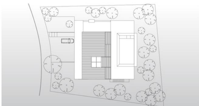
**Planta de Situação:** Vista ortográfica superior esquemática com abrangência de toda a zona que envolve o terreno onde será edificada a construção projetada, com a finalidade de identificar o formato, as dimensões do lote e a amarração deste no quarteirão em que se localiza.
