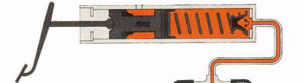
FREIO EM SOLTO. Quando o motorista reduz a pressão sobre o pedal, o fluido, ao retornar abre a válvula de retenção e penetra lentamente no cilindro mestre. Uma mola fecha a válvula para manter uma ligeira pressão no circuito.
