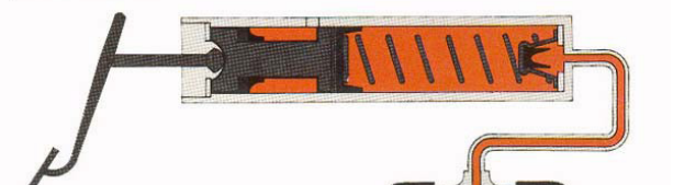
FREIO EM REPOUSO. Ao retornar, o fluido força o pistão do cilindro mestre para trás até que fique descoberto o furo da tubulação de ligação do reservatório. A mola do cilindro do freio mantém os vedadores de borracha encostados aos pistões.
