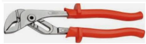
**Alicate Groovelock:** É uma inovação do alicate tipo bomba d'água, onde a abertura das mandíbulas é feita com simples apertar de botão central. Utiliza-se para apertos e desapertos de porcas e parafusos de diversas medidas.
