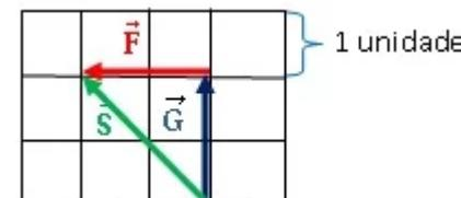
Desenhamos o vetor G, depois desenhamos o vetor F na extremidade (ponta) do vetor G. O vetor resultante é um vetor que começa no início do vetor G e termina na ponta do vetor F.
