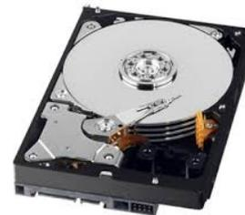
O HD é o item responsável pelo armazenamento de dados permanentes (os dados armazenados no HD não são perdidos quando o computador é desligado, como é o caso da memória RAM). O HD é o local onde é instalado e mantido o sistema operacional, todos os outros programas que são instalados no computador e todos os arquivos que do usuário.
