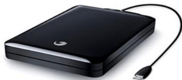
Os HDs externos são discos rígidos portáteis com alta capacidade de armazenamento, chegando facilmente à casa dos Terabytes. Eles, normalmente, funcionam a partir de qualquer entrada USB do computador.
