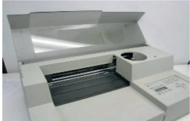
Plotter HP 7550A, um dos primeiros plotters a pena com o carrossel ou disco de penas e o detalhe do recipiente de encaixe do carrossel. Abaixo, o carrossel e a foto ampliada da pena amarela.
