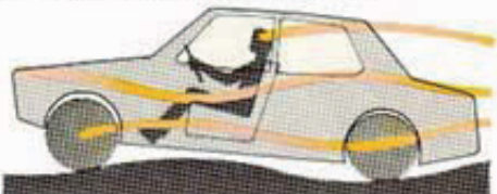
AUSÊNCIA DE AMORTECEDORES O automóvel oscilará continuamente para cima e para baixo, a menos que as oscilações sejam absorvidas pelos amortecedores.
