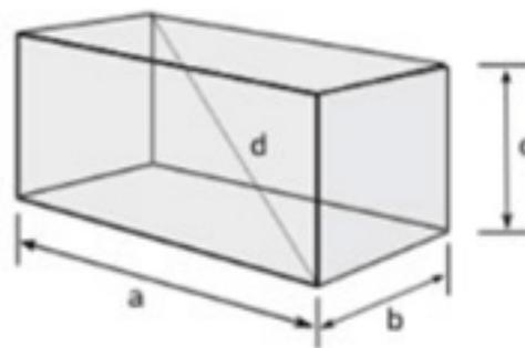
Diagonal de um paralelepípedo:  $d = \sqrt{a^2 + b^2 + c^2}$ .
