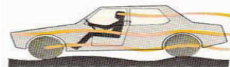
AUSÊNCIA DE SUSPENSÃO Todas as irregularidades da superfície da faixa de rodagem são transmitidas aos ocupantes do automóvel.
