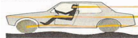
SUSPENSÃO EFICIENTE As rodas movem-se facilmente para cima e para baixo; porém, graças às molas e aos amortecedores, os ocupantes do automóvel não sentem esses movimentos.
