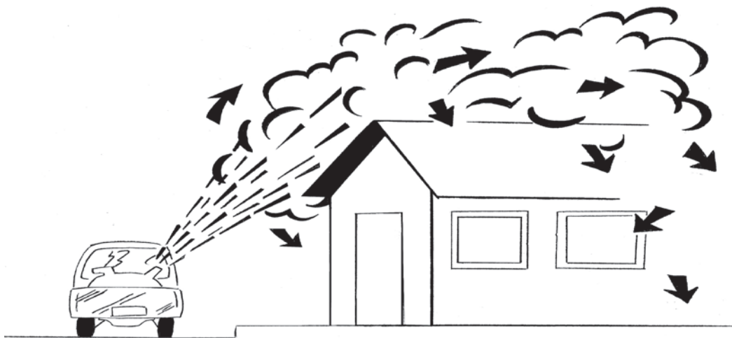
Figura 20. Dispersão da neblina em aplicações espaciais a Ultra Baixo Volume
